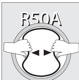
R50A - der Festsitz am Außendurchmesser kann durch Einkleben verbessert werden. Es ist besonders wichtig, dass Bohrung und Dichtring-Außendurchmesser fettfrei sind.
